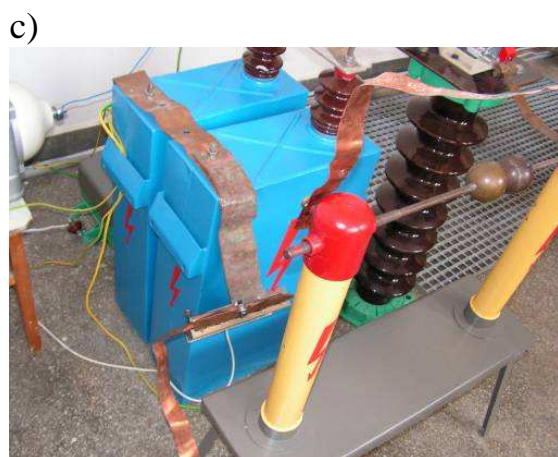
Rys. 10. Generator udarów napięciowo-prądowych: a) układ; b) obwód obliczeniowy; c) widok stanowiska badawczego
